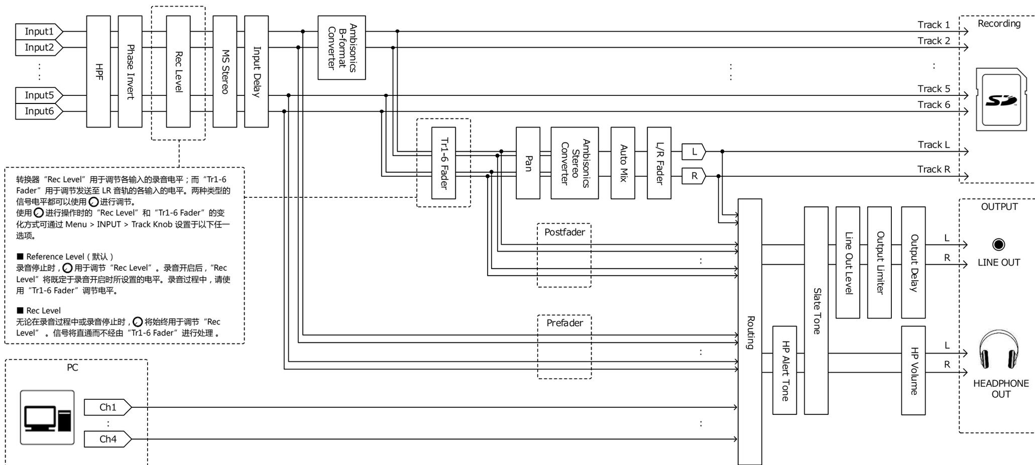
转换器“Rec Level”用于调节各输入的录音电平；而“Tr1-6 Fader”用于调节发送至 LR 音轨的各输入的电平。两种类型的信号电平都可以使用 进行调节。使用 进行操作时的“Rec Level”和“Tr1-6 Fader”的变化方式可通过 Menu > INPUT > Track Knob 设置于以下任一选项。
