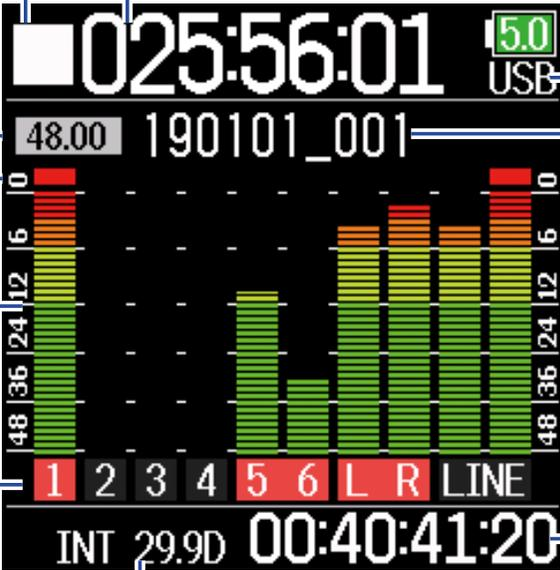
屏幕预览图显示：顶部有状态图标（停止）、计时器（025:56:01）、供电方式（5.0 USB）；中间有录音/播放采样率（48.00）、限幅指示灯（190101\_001）、电平表（0-48dB）；底部有音轨编号（1-6, L, R, LINE）、帧率（INT 29.9D）、录音/播放时间码（00:40:41:20）。
