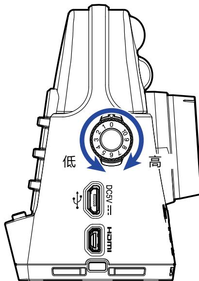
请调节该旋钮并确认电平表在最高音量时位于 -12 dB 上下。
