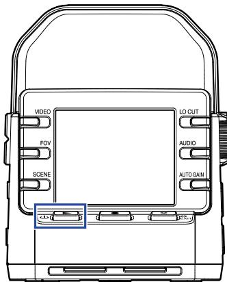
开机后，前面板的 REC LED 将亮起绿色，屏幕将显示录像界面。
