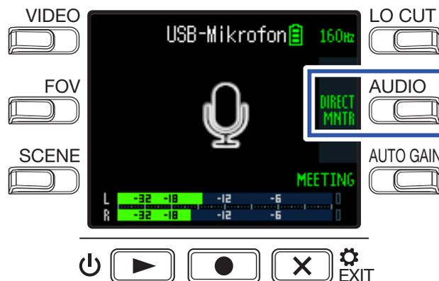
Dadurch wird das Direct-Monitoring an-/abgeschaltet (ON/OFF).
