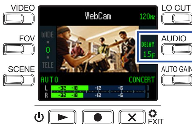
Drücken Sie **DELAY** wiederholt, um die Verzögerung des Audiosignals schrittweise zu erhöhen.
