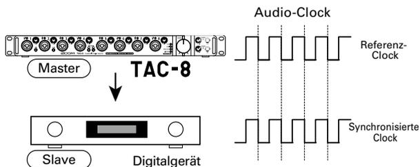
Der **TAC-8** ist als Master konfiguriert und die Clock des **TAC-8** ist auf das andere digitale Gerät synchronisiert.
