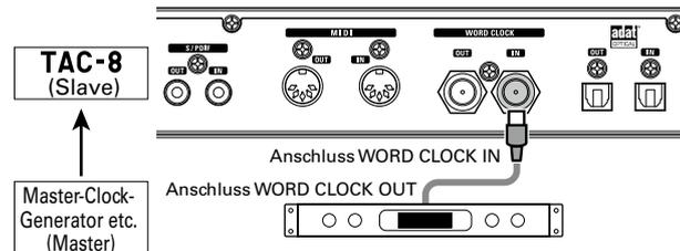
5. Die CLOCK-SOURCE-Anzeige WORD CLOCK leuchtet und zeigt an, dass die Geräte synchronisiert sind.
