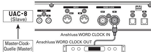
5. Die CLOCK-SOURCE-Anzeige WORD CLOCK leuchtet und zeigt an, dass die Geräte synchronisiert sind.
