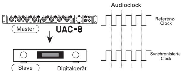
Der **UAC-8** ist als Master konfiguriert und die Clock des **UAC-8** ist auf das andere digitale Gerät synchronisiert.
