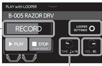
Touchez pour ouvrir l'écran des réglages du looper. La fonction d'annulation UNDO peut être activée/désactivée et la méthode d'arrêt et la position du looper peuvent être fixées.
