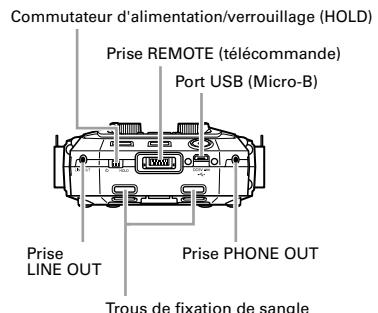
En connectant un BTA-1 ZOOM ou un autre adaptateur sans fil dédié à la prise REMOTE et en utilisant l'appli de contrôle dédiée, le H8 peut être piloté à partir d'un appareil iOS/iPadOS.
