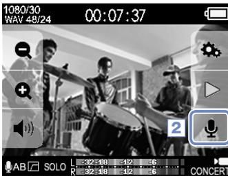
3. Touchez Plug-in Power dans l'écran INPUT SETTING et réglez le paramètre sur On.
