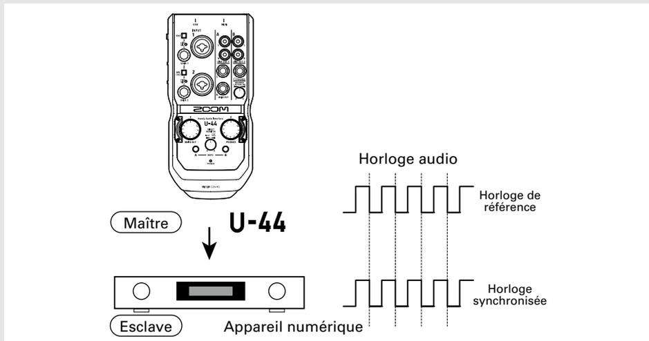
L'**U-44** fonctionne comme maître et l'horloge audio de l'autre appareil numérique est synchronisée sur la sienne.
