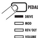
Il tasto [PEDAL] seleziona il modulo che sarà controllato dal pedale d'espressione. Il modulo attualmente selezionato è indicato dalla fila di LED proprio sotto il tasto. Ogni pressione del tasto attiva ciclicamente le impostazioni DRIVE → MOD → REV/DLY → VOLUME. Il parametro controllato con ogni impostazione è descritto sotto.
