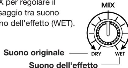
Per effetti come compressore/limitatore o simulatore microfono, in cui l'uscita è il suono originale processato, girare il comando MIX completamente verso WET.
