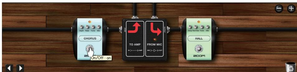
Lo strumento sarà spento, e bypassato. Per abilitarlo nuovamente, cliccate ancora una volta sull'interruttore a pedale.
