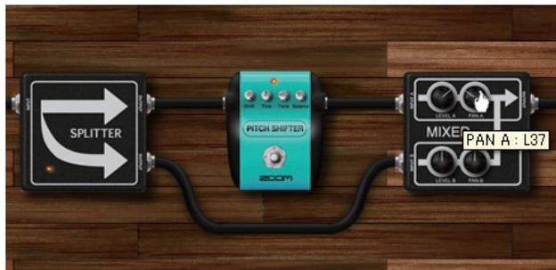
Il panning del canale A è regolato. Ruotate in senso orario verso R, e in senso antiorario verso L. Per il panning del canale B, ruotate la manopola [PAN B].
