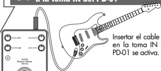
Insertar el cable de la guitarra en la toma IN del PD-01. El PD-01 se activa.
