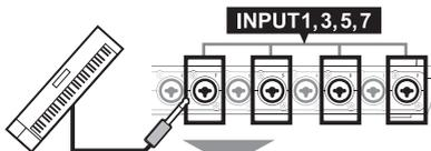
Utilice las entradas 1/2, 3/4, 5/6 y 7/8 como pares. Dé entrada a las señales del lado izquierdo en las pistas impares y a las del lado derecho en las pares.
